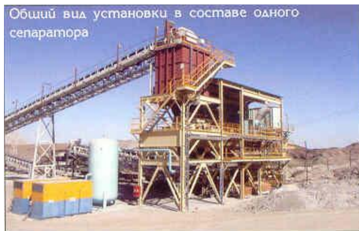
Рис.5. Установка с радиометрическим сепаратором
