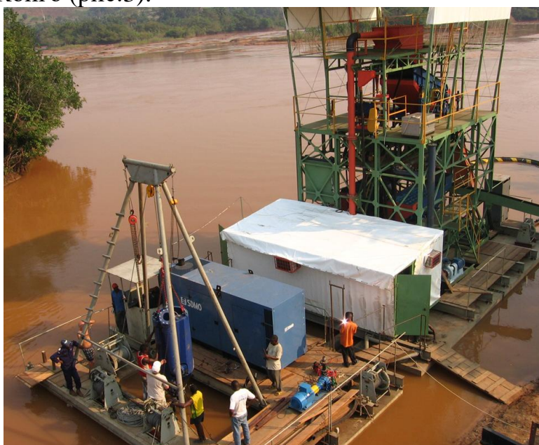
Рис.3. Сборно-разборная установка производительностью 10 – 12 т/час, смонтированная на катамаране
