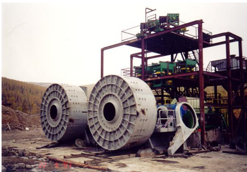
Рис.6 . Пример применения мельниц самоизмельчения производительностью 15 -20 т/час
