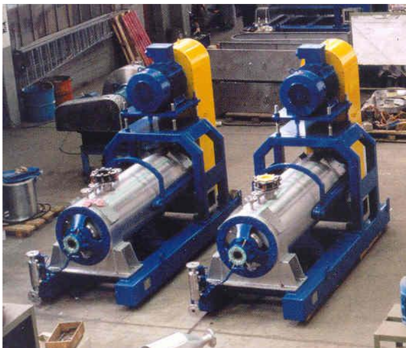
Рис.8. Осадительные центрифуги производительностью 15 – 20 т/час
