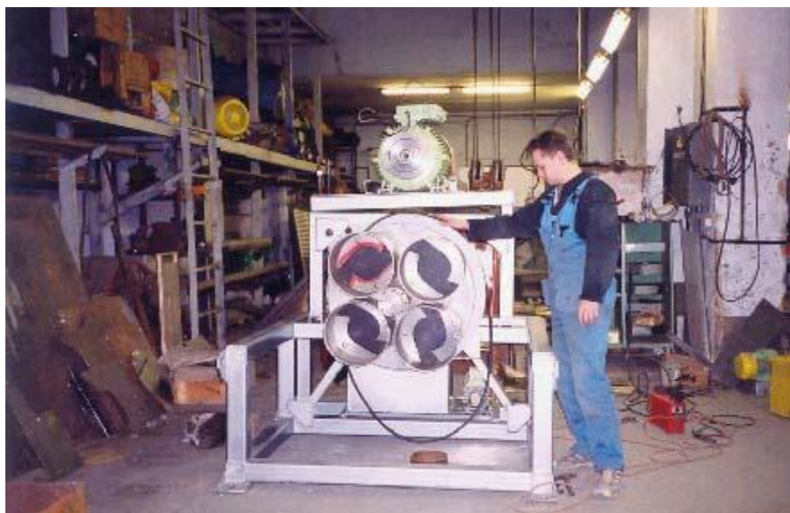
Рис. 7. Планетарная мельница для доводки золотосодержащих концентратов
